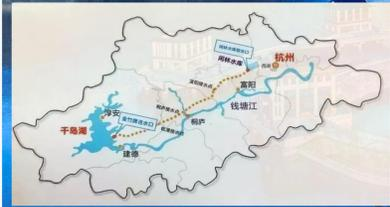
配水工程西起淳安县金竹牌村，途径淳安县、建德市、桐庐县、富阳区和余杭区境内，东至余杭区闲林水库。全长113.22公里，洞径6.7米，全封闭输水。规划每年配水量达9.78亿吨。
